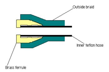
\*\*\*\* INNER TEFLON AND OUTER BRAID SHOULD BE THE SAME LENGTH AFTER CUTTING!!!!!
